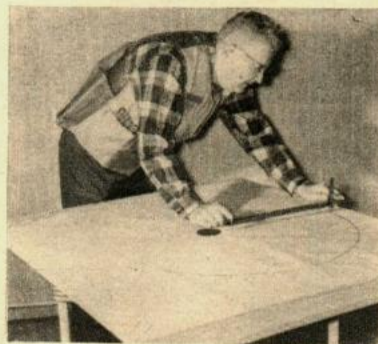
POUR DETERMINER LA REPARTITION de l'essai, donc les pourcentages, décrivez un cercle de 750 mm de diamètre autour de la plus grande concentration de trous de plomb. Voir détails pour l'appareil à tracer.
