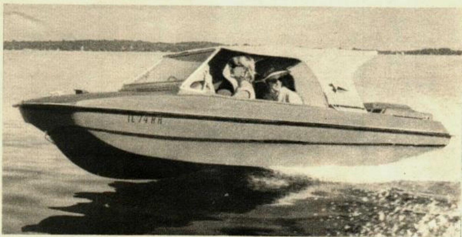
LE MOTEUR STANDARD pour le Caprice de 4,50 m est le moteur de tableau Johnson à 2 temps de 90 CV. C'est un petit runabout très nerveux. Le pare-brise peut être complètement rabattu pour ceux qui aiment sentir le vent, sinon l'aération modérée se fait par une fente qui occupe toute la largeur sous le pare-brise.
