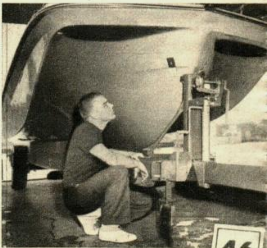
LES LIGNES ELEGANTES DE LA COQUE triédrale distribue le choc des vagues sur une grande surface, ce qui donne une allure confortable. Remarquer les feux de position encastrés dans la proue.
