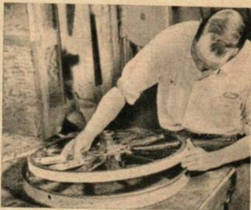
LES ANCIENNES ROUES EN BOIS prennent souvent du jeu ; Francis coince une bande de bois entre la roue et la jante.
