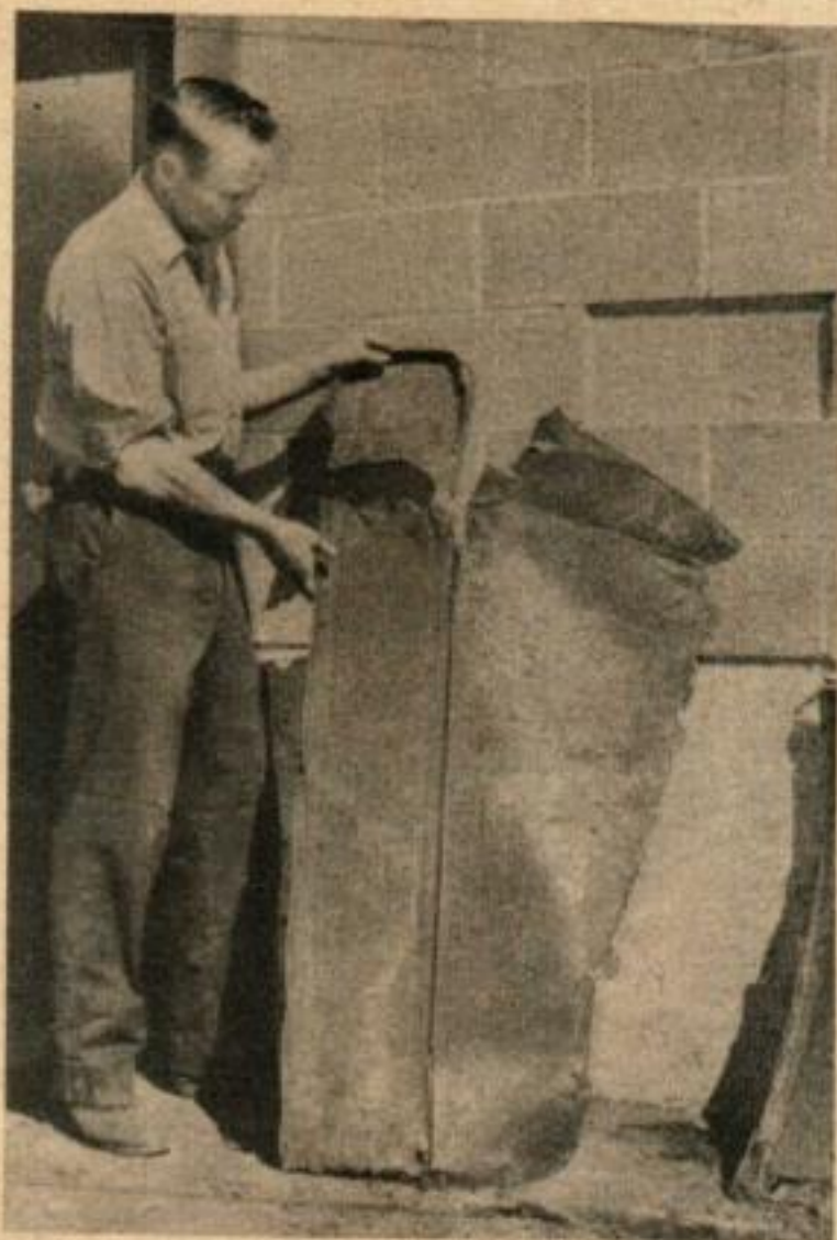
CES TOLES ROUILLEES sont tout ce qui reste des ailes d'une Flanders 1911 ; elles ne serviront que de modèle pour les nouvelles (ci-dessous) que l'on fabrique à la main à partir de tôle d'acier.
