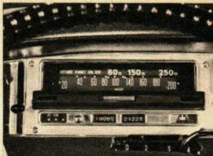
Ce cliché montre, chez la « DS 21 », un dispositif spécial : Citroën a fait figurer sur le tachymètre trois chiffres qui expriment en mètres la distance qu'il faut, par temps sec, pour arrêter la voiture à trois vitesses primordiales : 100 km-h, 140 km-h et 180 km-h.
