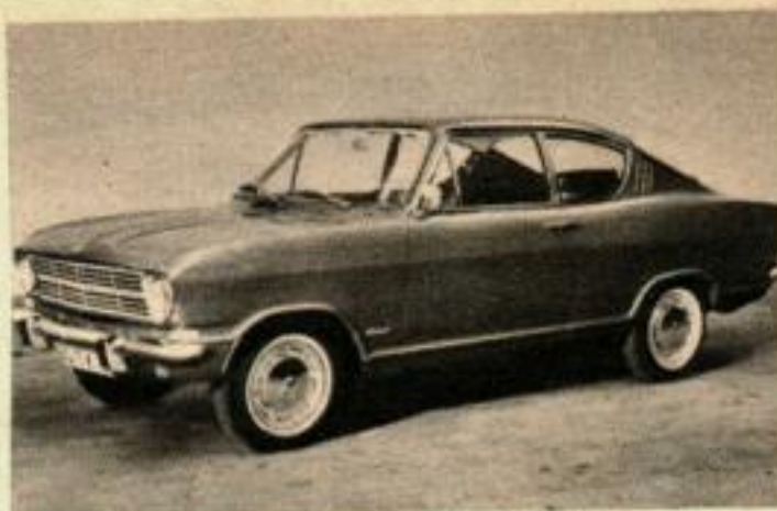
Le moteur « Super » de 1,1 litre qui équipe le nouveau coupé « Opel Kadett » développe 59 CV à 5 600 t/m et permet d'atteindre une vitesse maximum de 146 km/h avec des accélérations de 0 à 100 km/h en 18 secondes.
