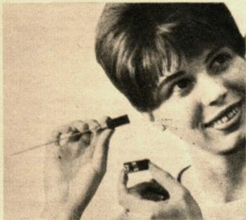
LE MINUSCULE POSTE DE RADIO qui capte les émissions amateurs a un écouteur caché dans l'une de ses extrémités. Il doit être élevé à la hauteur de l'oreille pour être entendu. L'autre petit paquet contient la batterie et le conjoncteur-disjoncteur pour faire marcher le poste.
