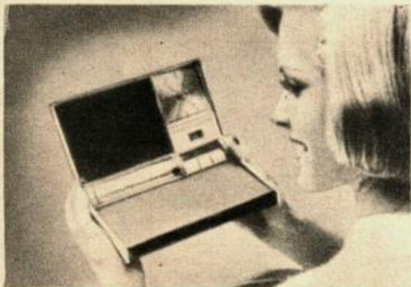
CE RECEPTEUR PORTATIF DE TELEVISION , grand comme un poudrier ou un porte-billets, donne une idée de ce à quoi travaille la Radio Corporation of America. Ce poste miniature n'est pas encore produit en série aujourd'hui, mais sa commercialisation n'est plus très éloignée.
