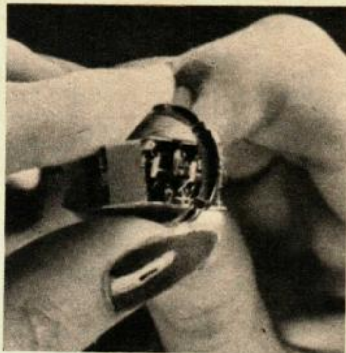
L'AMPLIFICATEUR MOLECULAIRE est une pièce importante des systèmes de radar et de communication de l'Aéronautique et de l'Espace. L'appareil se compose de plusieurs circuits intégrés indépendants.
