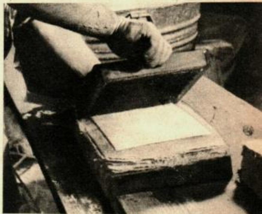
UN SIMPLE FEUILLE est formée par une couche de pâte disposée sur le moule (montré au moment où il est retiré de la cuve sur l'autre page). Ici, la feuille humide est posée sur un morceau de feutre.
