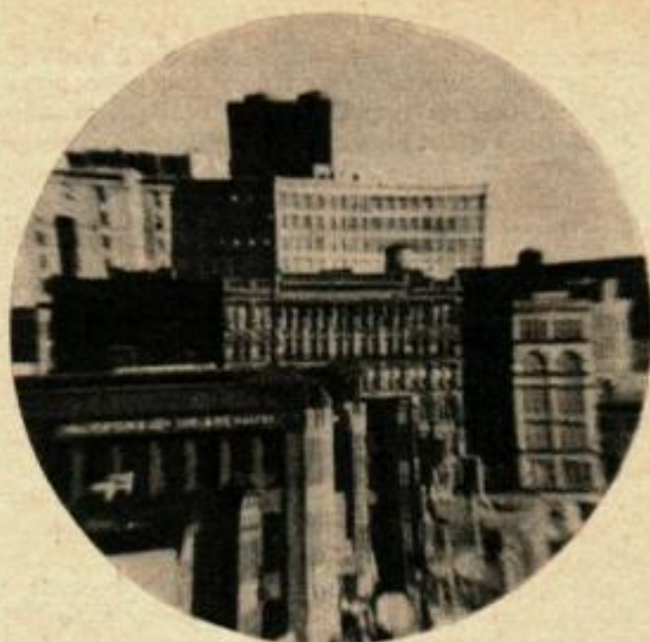
UNE DEFORMATION EXCESSIVE est évidente dans cette jumelle. Remarquez de quelle manière l'image est brouillée et les lignes verticales et horizontales tordues, au point que l'instrument n'est plus d'aucune utilité.
