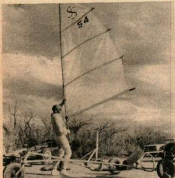
IL A FALLU deux ans d'essais et d'expériences pour arriver à la voile de Dacron de 4 mètres qui rend l'engin sûr, rapide et facile à manœuvrer.
