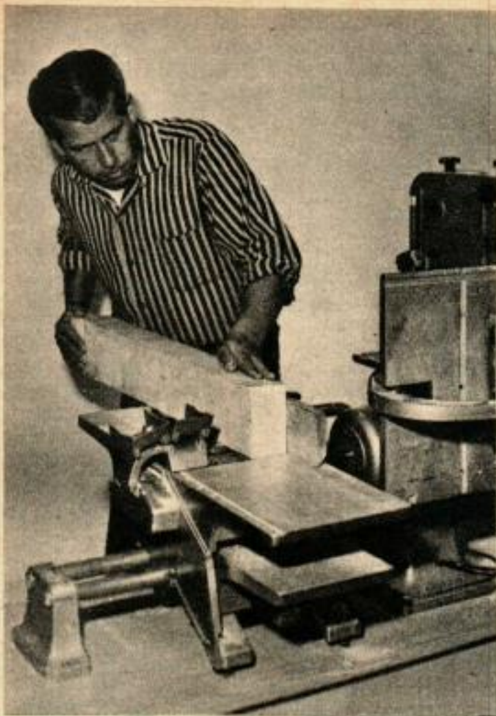
Notre photo montre la dégauchisseuse Emco-Rex, connue familièrement comme « dégau-rabot ». L'artisan tient un chevron qu'il est en train de dégauchir. C'est la partie inférieure qui sera travaillée.
