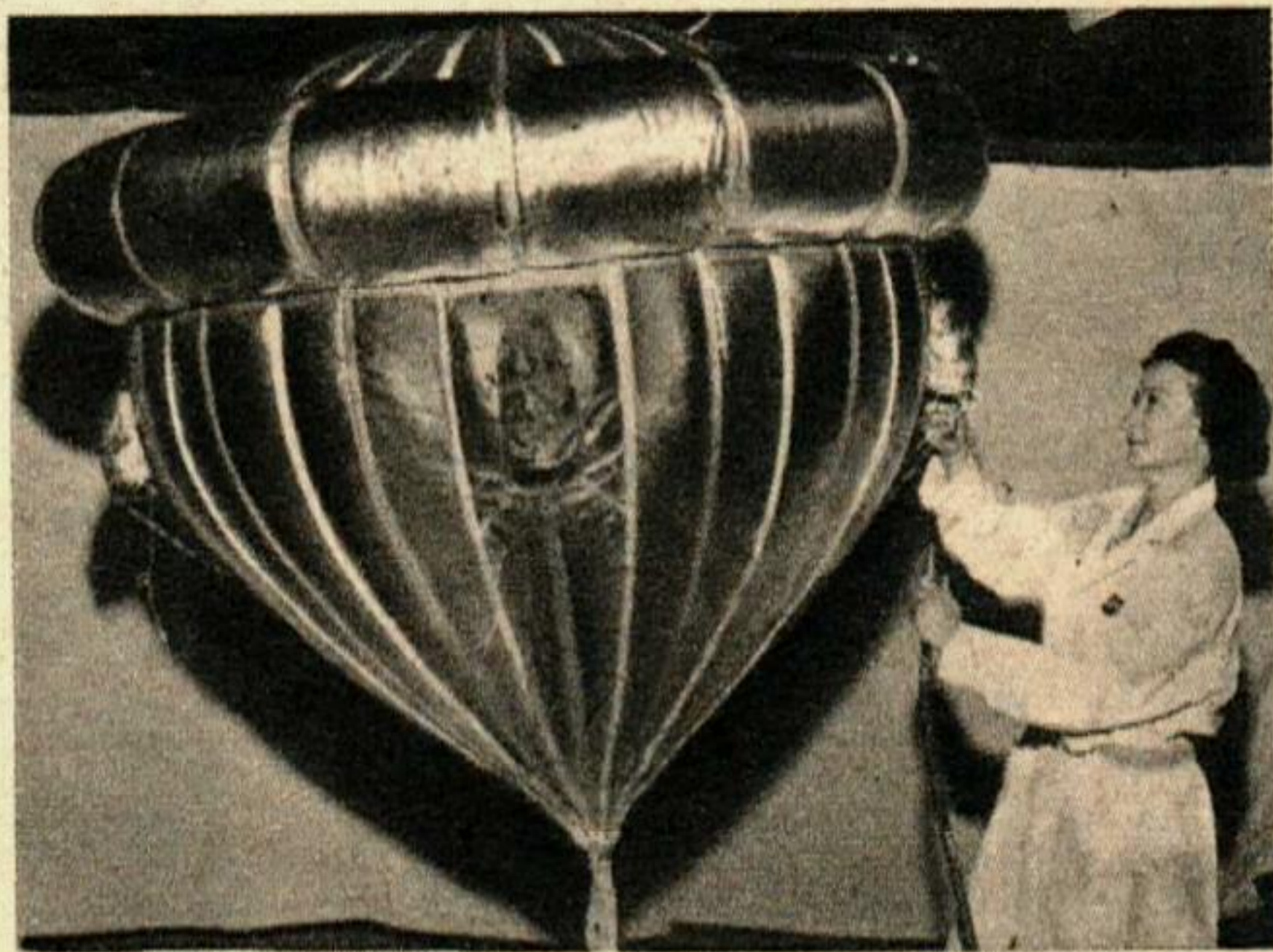
Le Ballute (contraction de ballon-parachute), mis au point par la Division Aérospatiale de Goodyear, faisait partie de l'équipement des astronautes Virgil Grissom et John Young de la fusée Gemini lors de leur vol du 23 mars.
