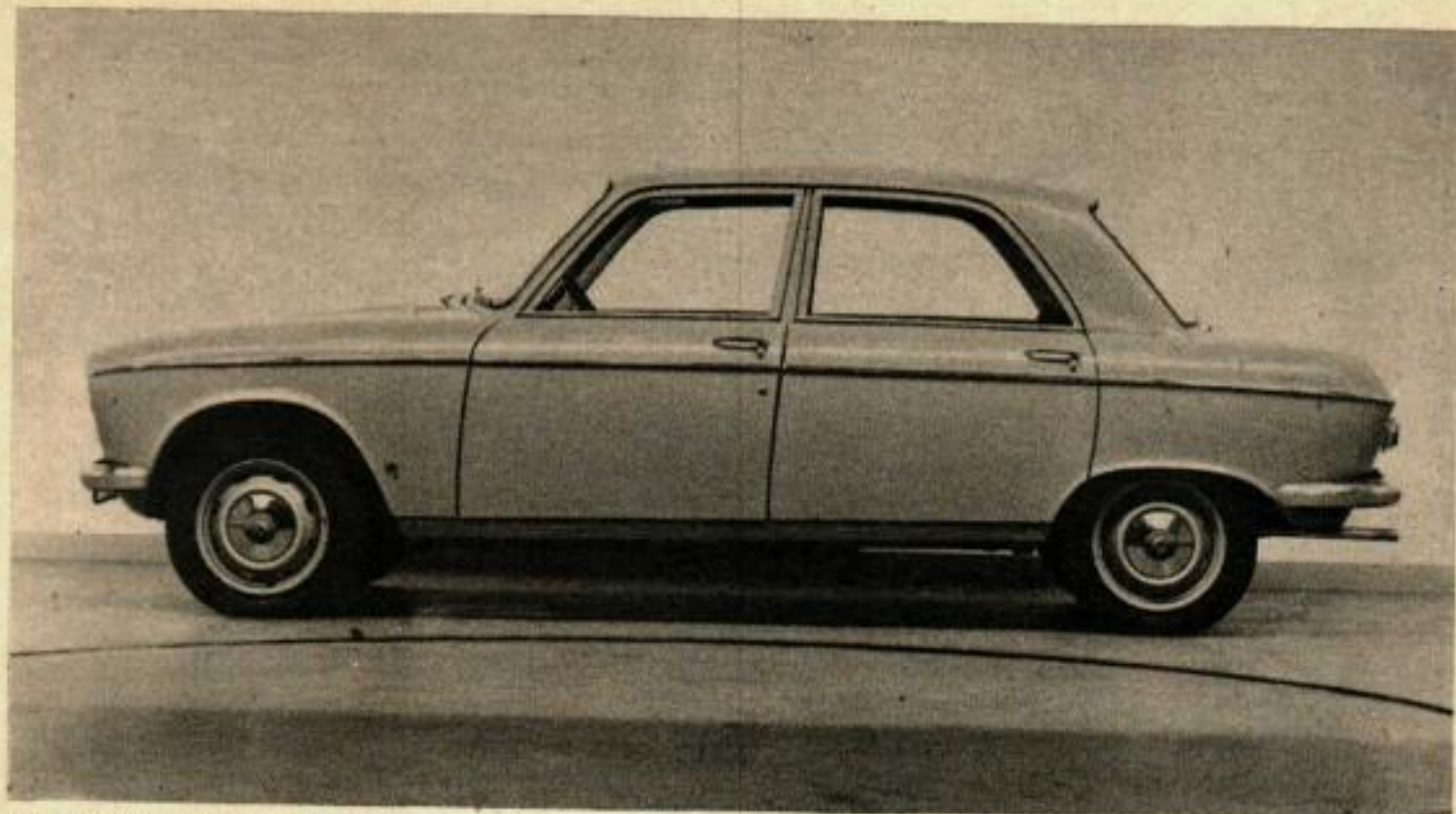
La Peugeot « 204 », traction avant d'une conception toute particulière, fait montre d'une sobre élégance, due en large partie à la collaboration de Pinin Farina. La carrosserie offre un grand habitacle, malgré une très modeste longueur hors tout inférieure à quatre mètres.
