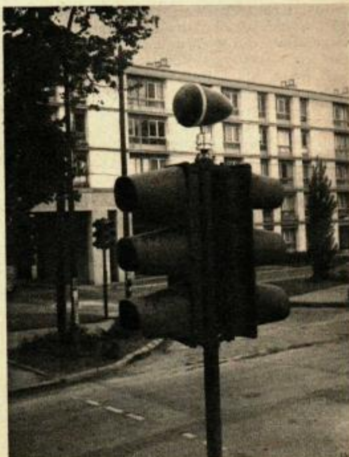
Pour ce qui est des compteurs, voici un radar qui se place facilement sur un poteau tricolore. Ce dispositif, émettant des faisceaux radio à l'allure de 9 000 000 de cycles à la seconde, compte le nombre de véhicules qui passent dans les deux sens, et indique également leur vitesse moyenne.
