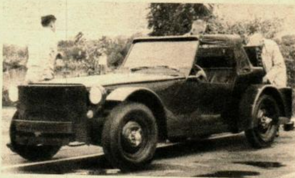
LE MOTEUR A QUATRE CYLINDRES en ligne de cette réalisation est basé sur un cycle breveté. Le châssis est un Ford ramené à 2,50 m d'empattement, la carrosserie en aluminium.
