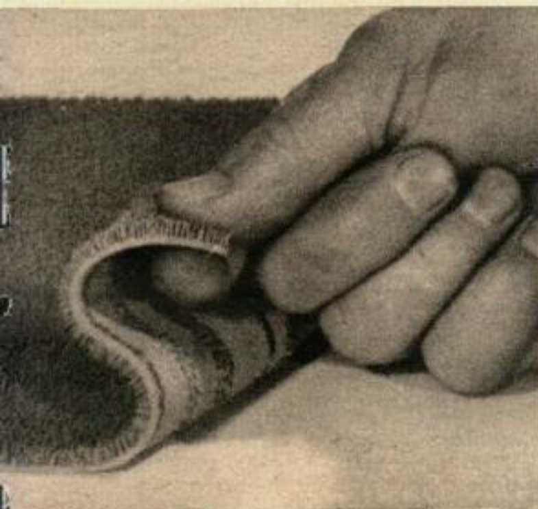
La surface du gazon artificiel ressemble à de petits brins d'herbe. Ce matériau peut être exposé à toutes les intempéries. On le fixe avec de la colle époxyde.
