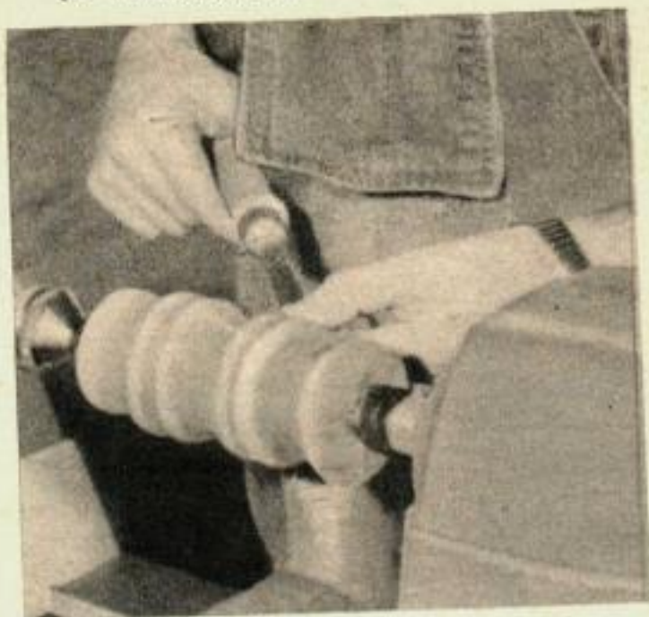
Le bois imprégné de matière plastique, bien que beaucoup plus dur que le bois ordinaire, peut être travaillé suivant les méthodes habituelles. On peut le scier, le percer, le tourner et le poncer.
