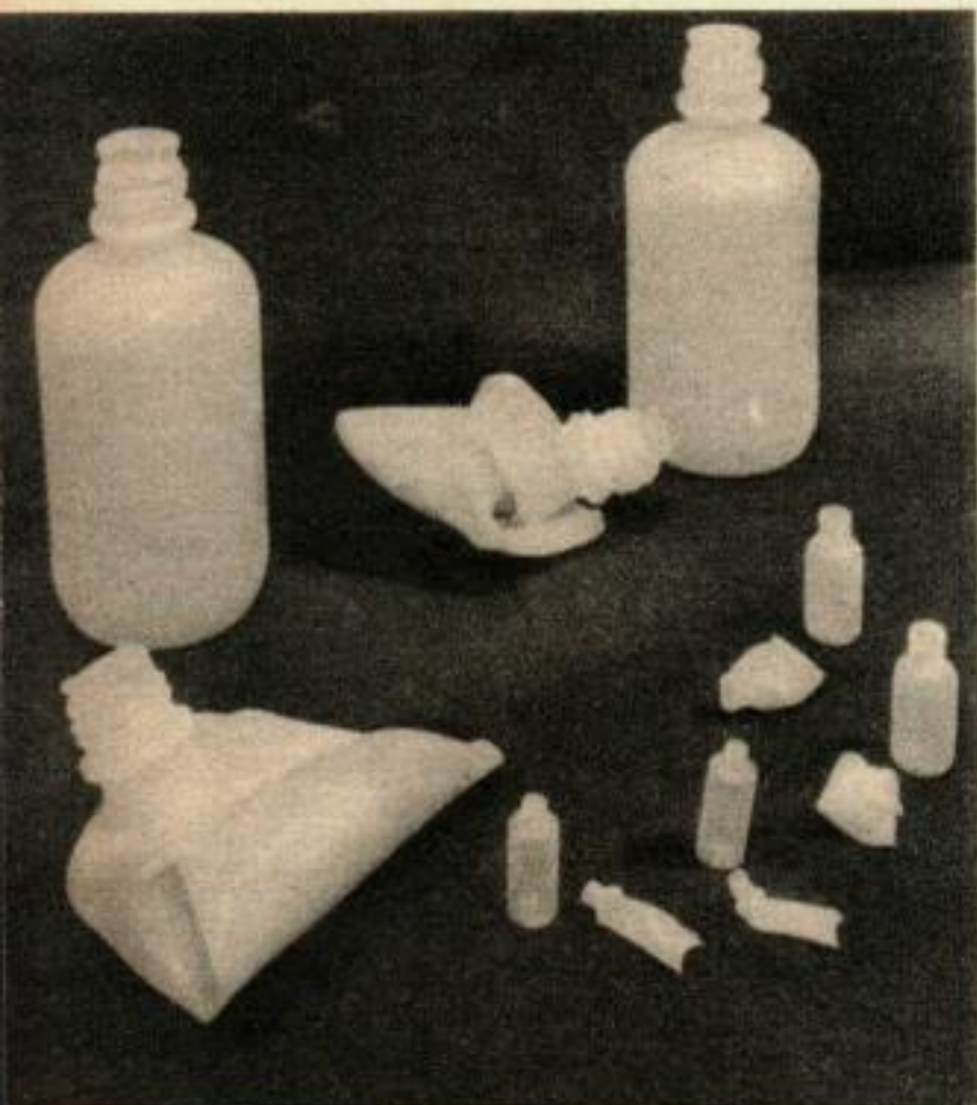
Les bouteilles de polyéthylène qu'on voit ici viennent d'être retirées de l'eau bouillante. Celles qui ont été irradiées ont conservé leur forme tandis que les bouteilles non traitées l'ont perdue.
