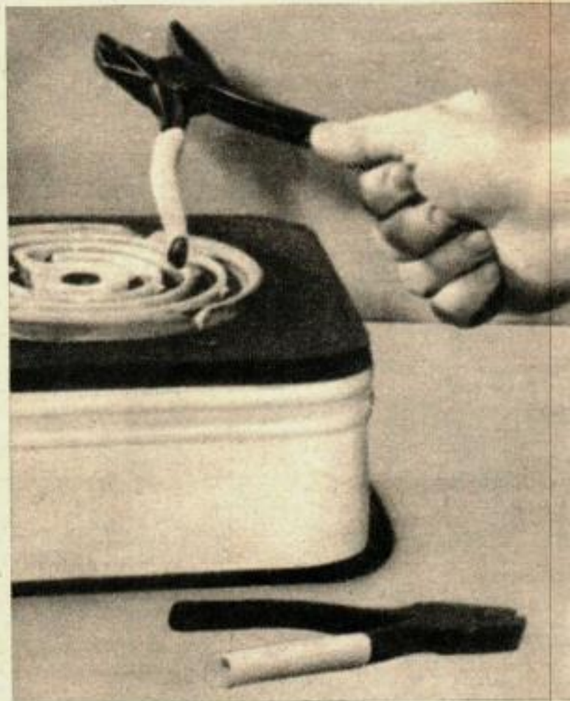
La gaine irradiée dans sa forme à froid se trouve sur la paire de pinces qui est en dessous. Un chauffage modéré contracte la matière plastique qui s'applique fortement sur la poignée pour former une gaine isolante.
