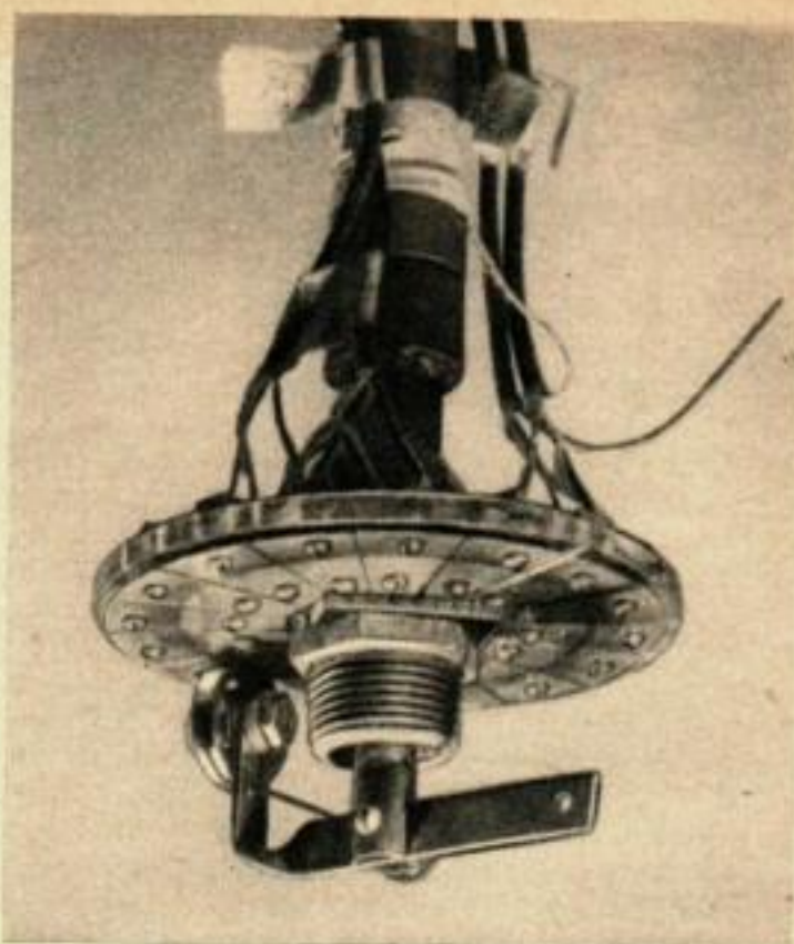
L'élément sensible est constitué par un bras monté au bas de la hampe et tournant sur un disque portant des secteurs de cuivre.
