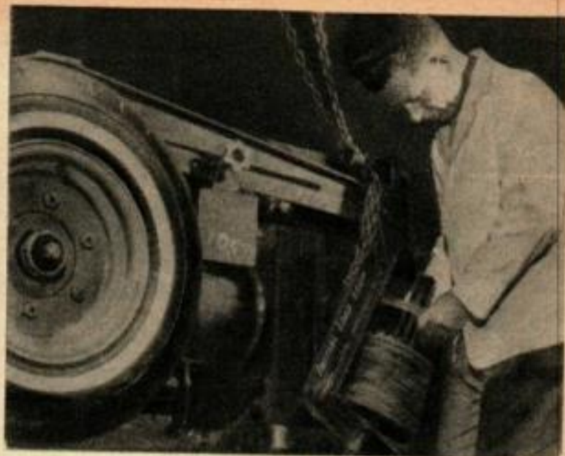
Des poids sont ajoutés au bras de la machine qui se prépare à faire rouler le pneu avec une charge donnée, à une vitesse connue, pendant un temps déterminé, au cours d'un des nouveaux essais.
