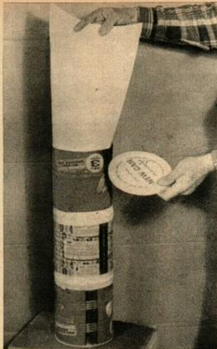
Le développement à sec dans les émanations d'ammoniaque donne une copie toute prête en quelques minutes. 50 grammes d'ammoniaque peuvent durer presque toute une journée si on prend soin de bien boucher le haut et le bas des boîtes.
