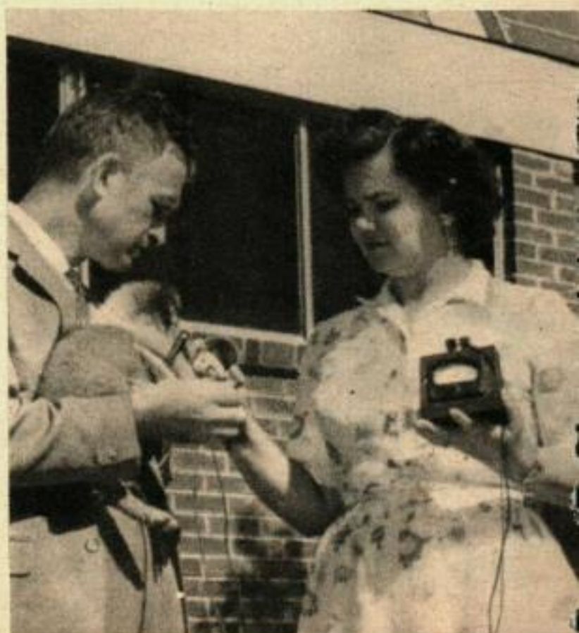
Le pyranomètre est utilisé par Thomason pour mesurer l'intensité de la lumière solaire. Cela donne une idée de la quantité d'énergie solaire absorbée par le système.
