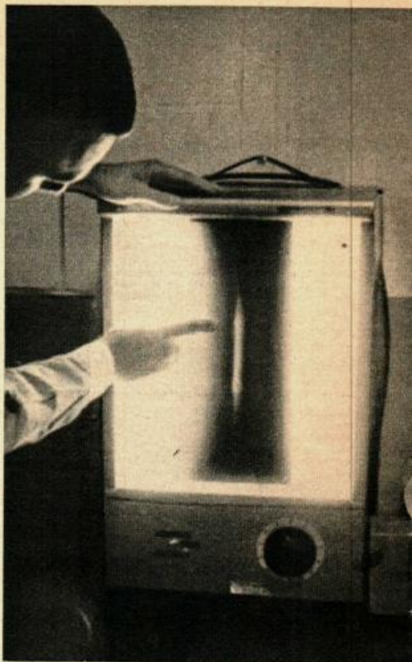
Un défaut grave, une solution de continuité dans la charge, très visible sur la photo aux rayons X. Une telle fissure peut causer une explosion au moment du lancement.
