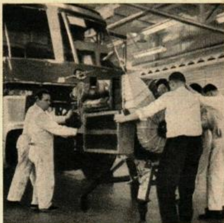
LA TURBINE DE LA FORD est en réalité un moteur double pouvant donner 45 CV pour le fonctionnement des appareils auxiliaires ou, en lançant le compresseur, la puissance totale de 600 CV.
