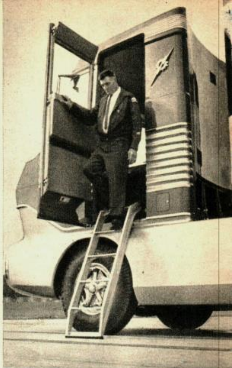
LA PORTE, qui fonctionne à l'air comprimé, s'ouvre et l'échelle fonctionnant à l'électricité descend. La cabine est légèrement pressurisée et les gaz du moteur ne peuvent y pénétrer.
