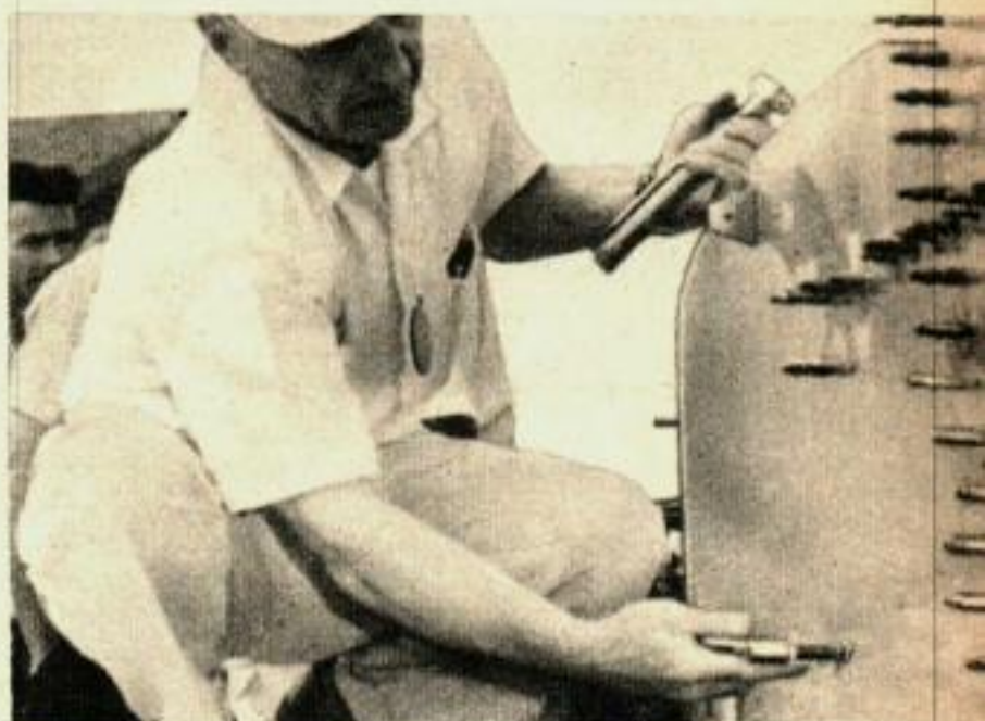
John Thorp démontre la méthode Cleco pour maintenir les éléments en place, éliminant les gabarits qui servent habituellement pour les constructions métalliques. Les éléments sont ensuite montés avec des rivets Pop.
