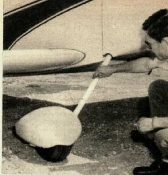
Le train d'atterrissage, une autre innovation, est en forme de A ; monté sur le fuselage derrière le moteur. Cet élément est parmi ceux qui peuvent être achetés par des débutants.
