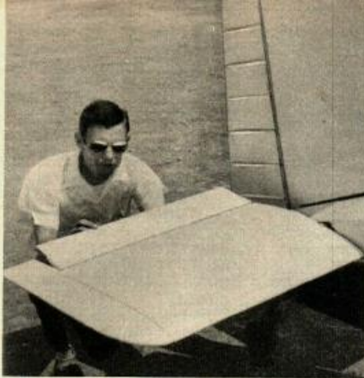
La « queue volante » conçue par Thorp est complètement mobile ; sans le plan fixe horizontal qu'on trouve habituellement. Bill Warwick a été le premier des 150 constructeurs de T. 18 à avoir terminé son avion.
