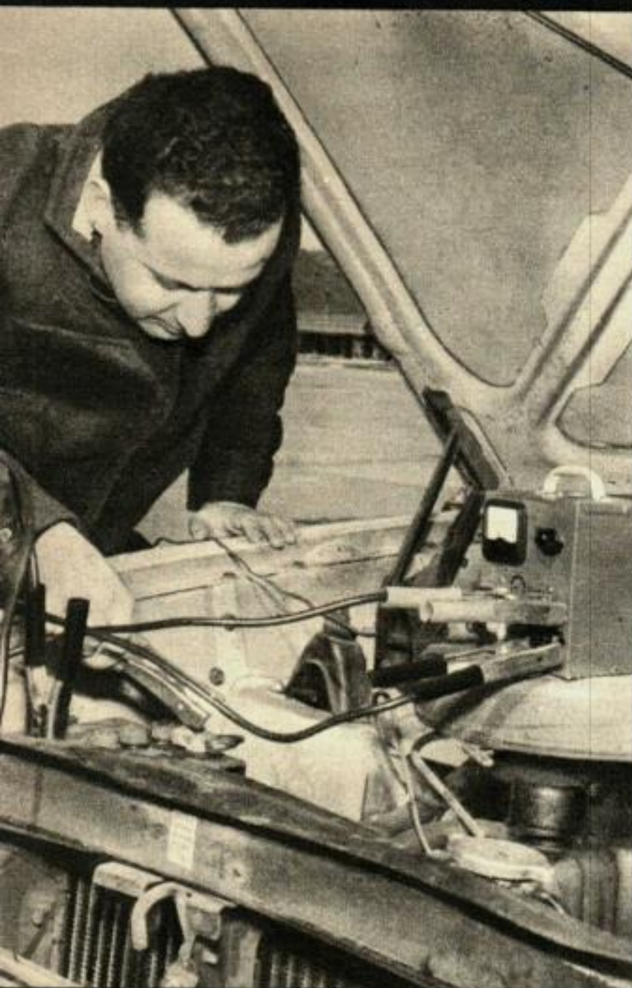
Vue du chargeur complet. Lorsque vous tournez le bouton « puissance », vous réglez la charge désirée.
