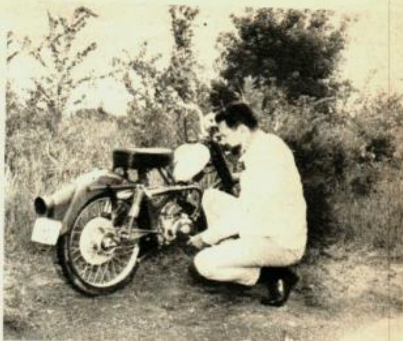
Pour rouler sur piste, le circuit d'échappement doit passer par-dessus le moteur. Il faut alors allonger le tuyau d'échappement. Le grand pignon de piste fait plus que doubler la démultiplication.
