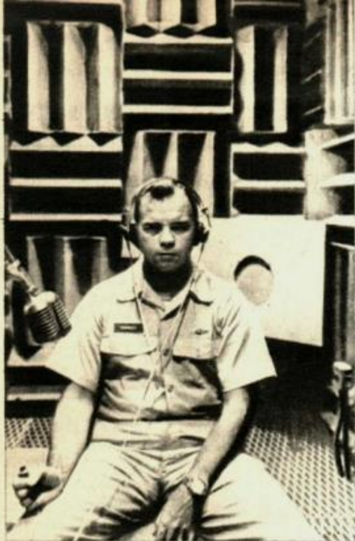
La chambre acoustique, montée sur ressorts et abondamment garnie de saillies absorbantes permet de juger de l'acuité de l'ouïe à l'aide d'un casque à écouteurs et aussi de vibreurs placés contre l'apophyse mastoïde en arrière des oreilles.
