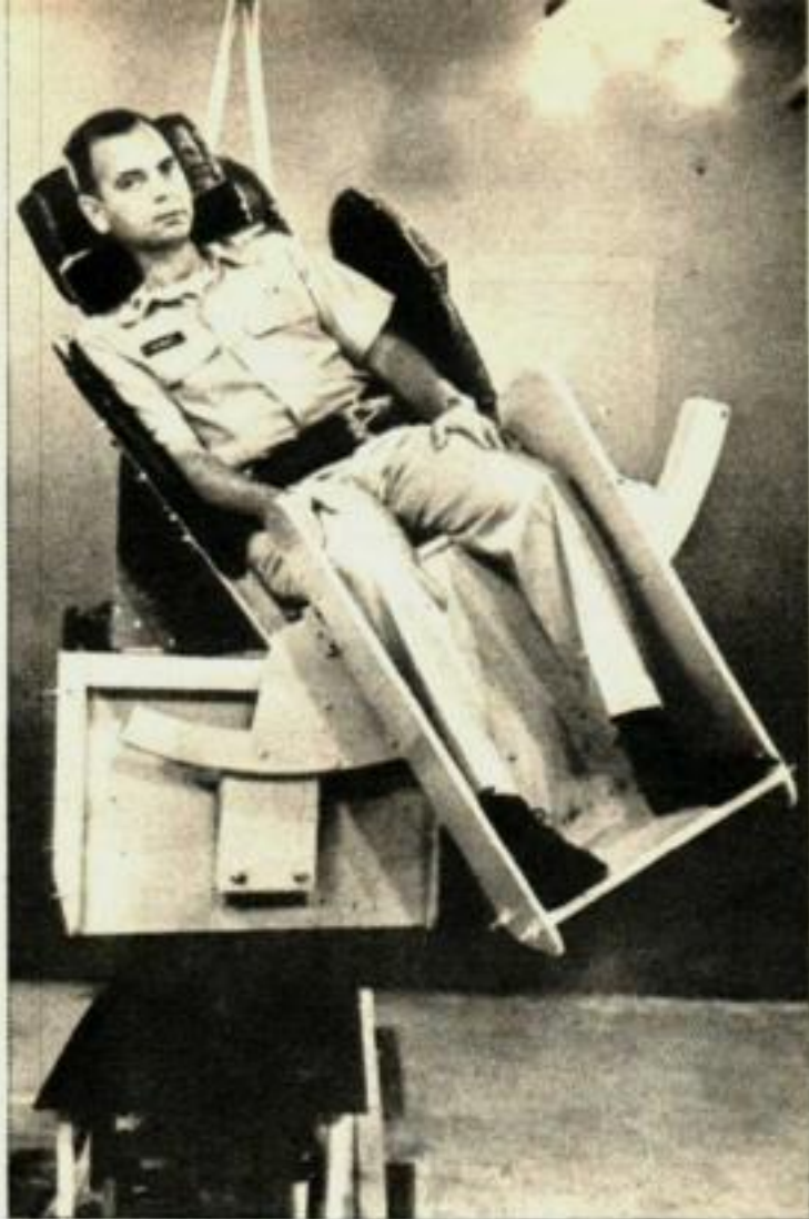
Le siège vestibulaire tourne sur lui-même tout en s'inclinant de part et d'autre. Cette photo est une pose parce que les tests proprement dits ont lieu dans une obscurité complète et produisant une désorientation terrifiante.
