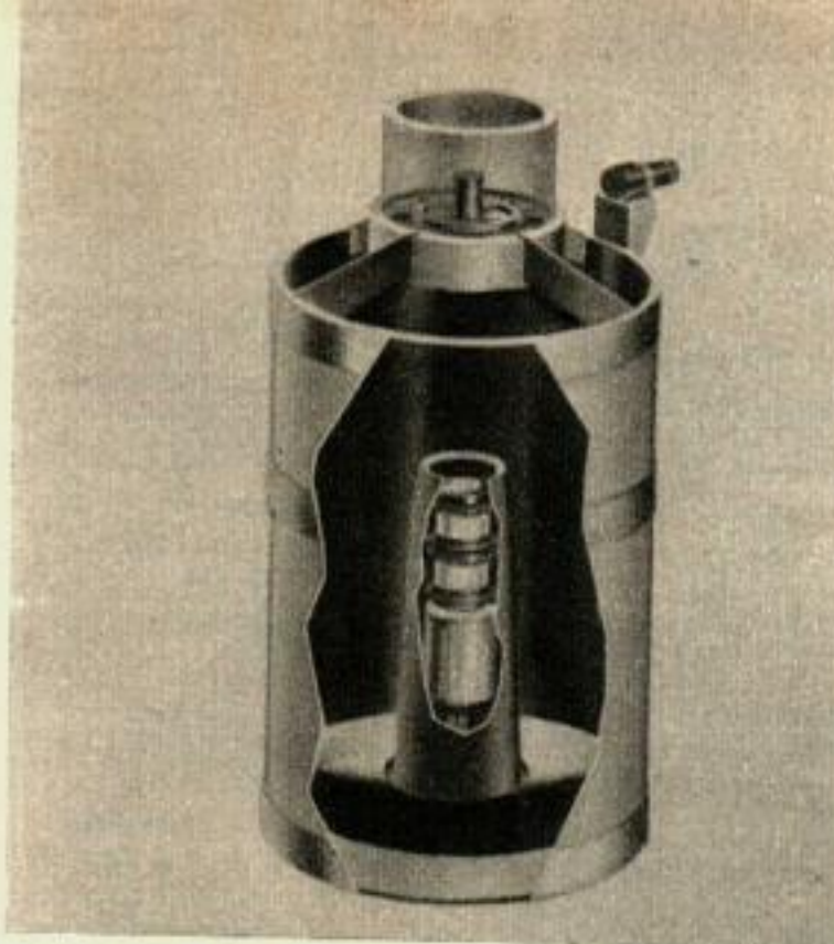
Un modèle des télescopes qui serviront à établir le cadastre du ciel. La camera T.V. sensible aux ultraviolets appelée Uvicon est montée sur le fond de l'instrument.
