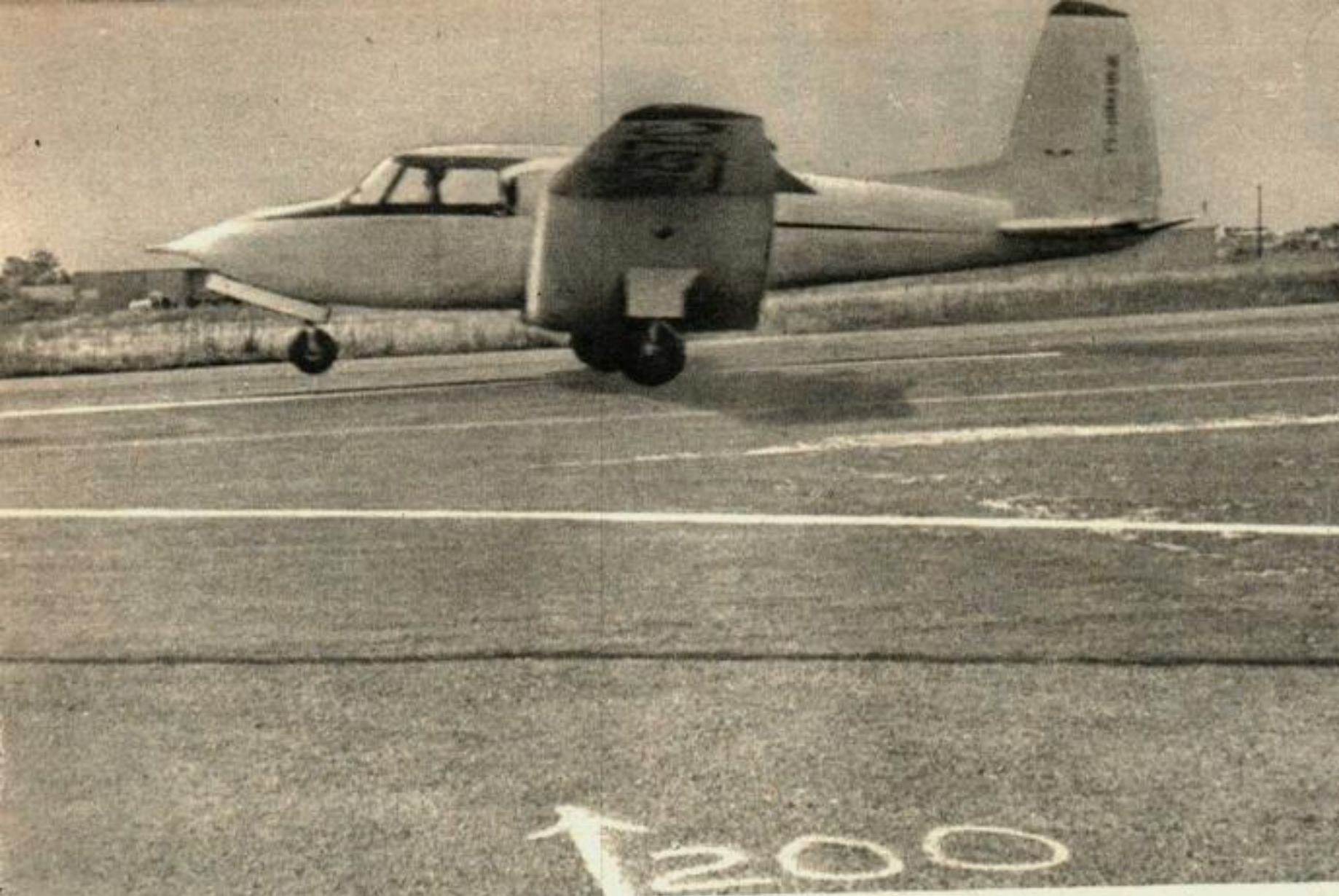
Le plus grand avantage de l'aile gouttière est qu'elle permet le décollage et l'atterrissage sur de petits terrains. Le prototype qu'on voit se cabre au bout de 60 m, et décolle au bout de 75 m. Le courant d'air aspiré par l'hélice par-dessus le berceau double la force de sustentation.
