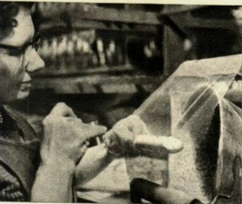
Des méthodes particulières de fabrication sont nécessaires pour la production des leurres. L'illusion des écailles de poisson est créée en projetant un jet de peinture à travers un grillage métallique.
