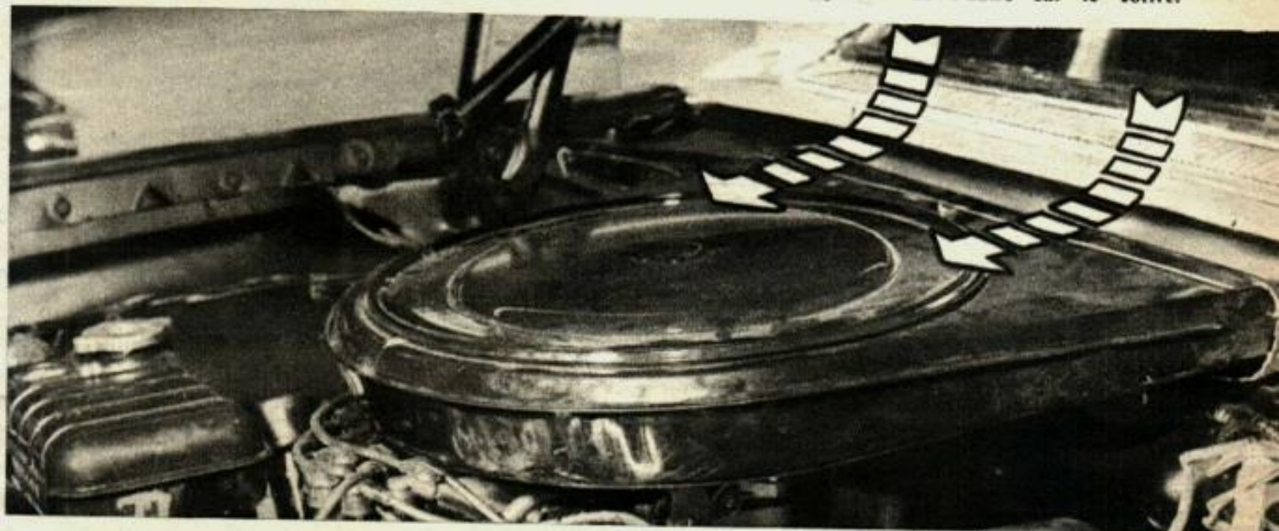
La compression aérodynamique chasse l'air vers le bas à travers les fentes d'aération, mais au lieu de servir à rafraîchir le conducteur, il est canalisé à travers la cloison pare-feu dans l'écran qui entoure l'énorme filtre d'air. A 255 km/h, cette compression peut équilibrer une colonne d'eau de 15 cm. La « Corvaire » 1965 aura une silhouette plus longue, plus arrondie et moins oblongue, avec quelques ressemblances avec celles de la « Corvette » Sting Ray, de la « Chevelle » et de la Buick « Riviera ». Seuls le châssis à plateforme et l'ensemble moteur - transmission - essieu seront relativement les mêmes pour 1965.
