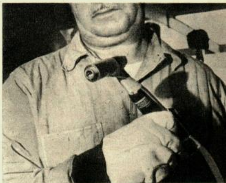
Le soudeur peut travailler en plein air avec ce chalumeau. Ce dernier porte deux ajutages concentriques qui projettent de l'argon sur la soudure, chassant l'air qui contaminerait le métal.
