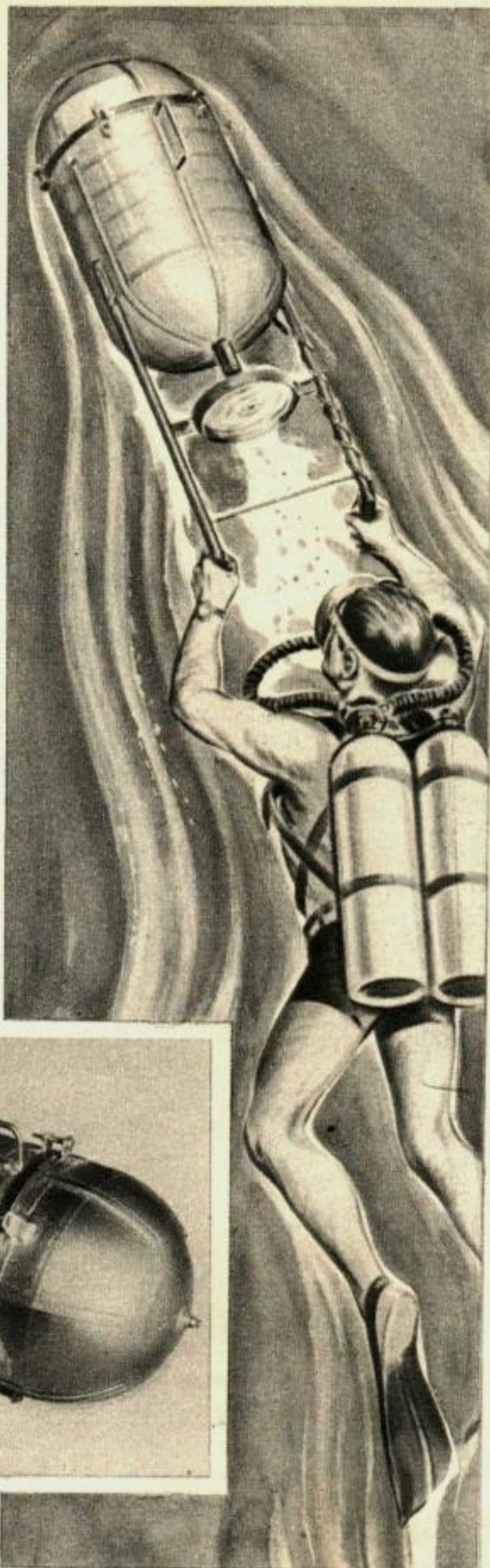
Un réservoir à oxygène des surplus et un moteur de 1/6 de CV provenant aussi des surplus, sont les pièces principales du tracteur. Actionné par une batterie de 12 volts, il a une autonomie de plusieurs heures.
