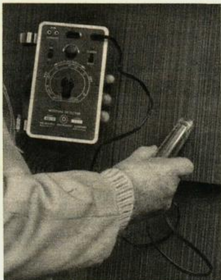
Un appareil à mesurer le degré d'humidité, réglé à un certain niveau, vous permet de déterminer si l'humidité présente n'est pas excessive.
