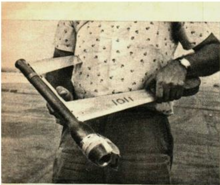
Ce très singulier avion à réaction n'a qu'une seule aile et un seul plan de profondeur. En éliminant une aile, on réduit la traînée et on obtient une vitesse plus élevée. Ce modèle a dépassé 300 km/h en vol.
