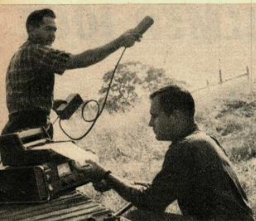
Les champs magnétiques des roches profondes se modifient avec les tensions telluriques. On pourrait peut-être prédire les tremblements de terre en mesurant ces variations avec des magnétomètres.
