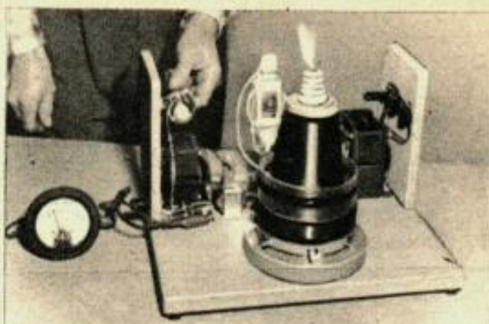
APRES LE MONTAGE , lire le courant plaque en intercalant un milli entre le milieu du transfo de chauffage et la masse. Régler le rhéostat pour avoir au plus 150 mA avec n'importe quel condensateur.
