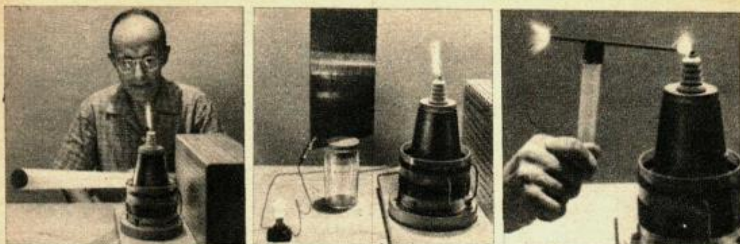
QUELQUES EXPERIENCES. A gauche, on allume un tube fluorescent rien qu'en le mettant dans le champ électromagnétique qui entoure la bobine. Au milieu, la lampe de 115 volts s'éclaire sans être branchée au secteur grâce à l'énergie reçue par la feuille métallique. A droite, on fait passer le courant à travers une tige métallique tenue par un support isolant, et l'aigrette de la bobine en donne une autre à l'extrémité.
