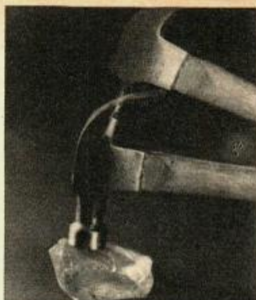
La flexibilité et la résistance constituent les caractéristiques des nouvelles résines. Le dispositif d'essai de traction sur la photo du centre montre que l'échantillon s'est étiré de 400 % par rapport à la dimension d'origine. Un morceau de résine reste flexible sous le choc au-dessous de -23^{\circ}\text{C} .
