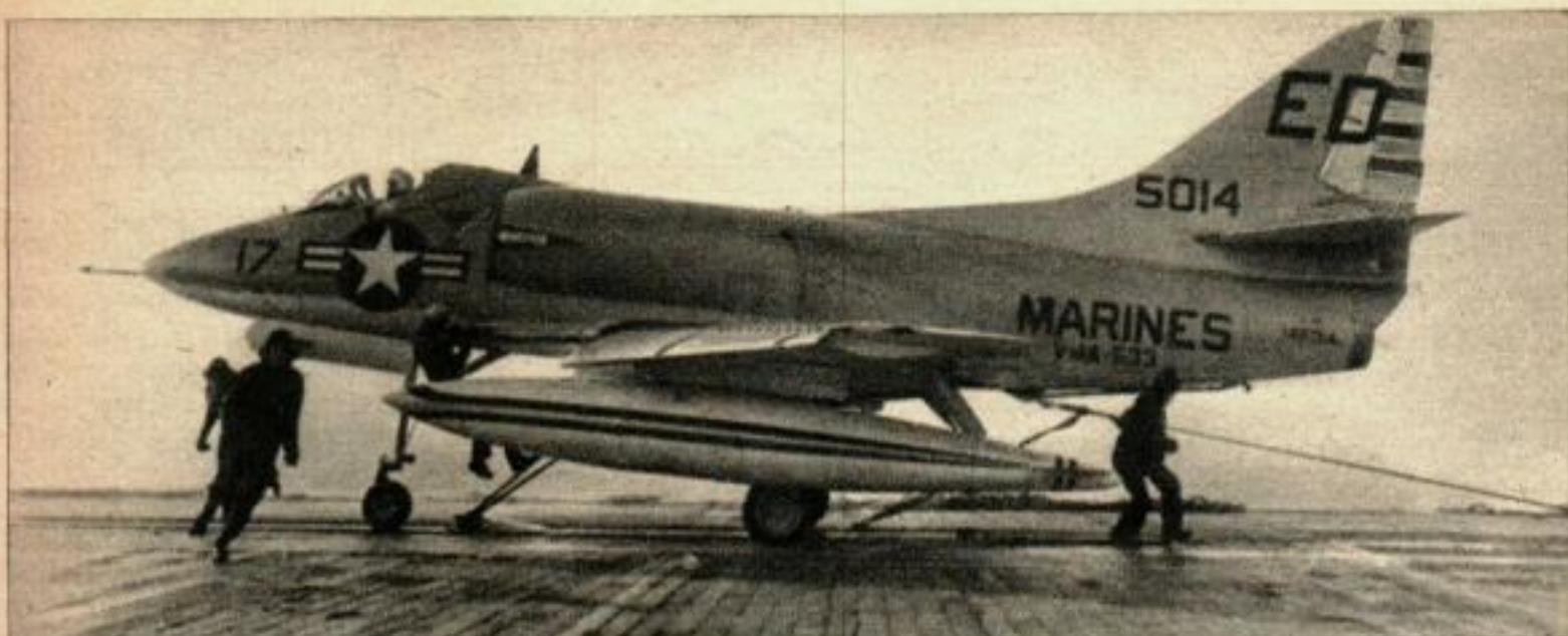
Les hommes de l'équipe de catapultage s'éloignent de l'avion au moment où il va mettre plein gaz. Le câble ayant fixé au piston tirera l'avion vers l'avant dès que la barre de tension attachée au câble arrière se sera rompue. On voit un homme peser sur le câble avant pour éprouver la tension.
