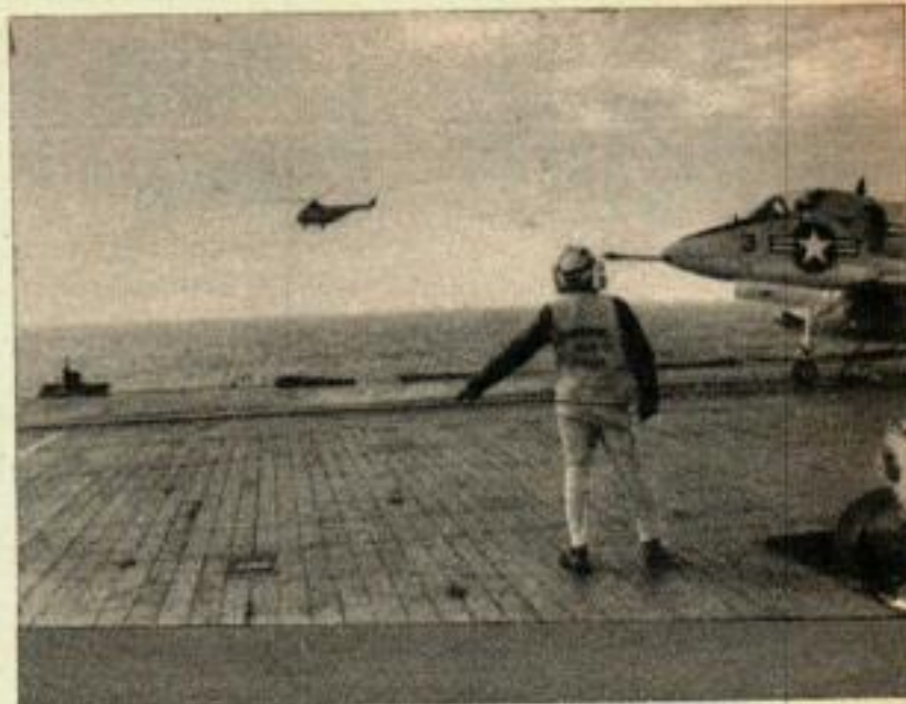
Le bras baissé donne le signal du décollage. L'opérateur de la catapulte (tout à fait à gauche) baisse alors la main droite et pousse sur le bouton « go ». Un hélicoptère en arrière-plan accompagne le navire.
