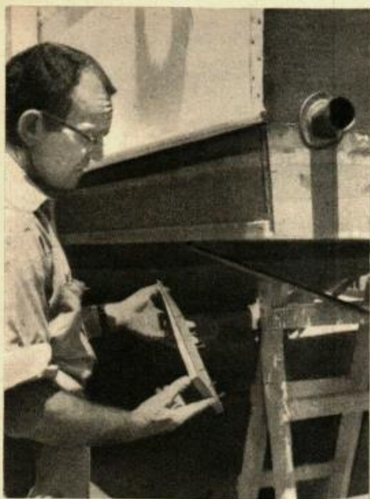
LE MONTAGE DES CALES sur la coque de bois ci-dessus, utilise des vis en plus de l'époxyde. Si on recouvre de fibre de verre, inutile de monter une garniture métallique. Dans les dessins ci-dessous, les épaisseurs des cales et de la fibre de verre sont exagérées.
