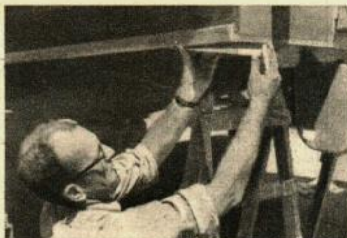
Les pièces extérieures doivent être carénées pour suivre le contour des flancs et du tableau arrière afin de ne pas provoquer de turbulences.
