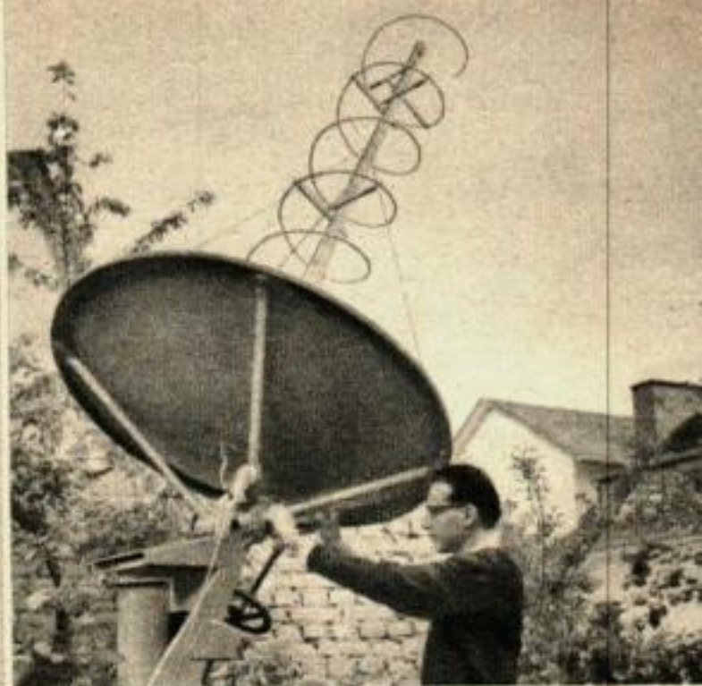
Oslender en train de régler le réflecteur parabolique et l'antenne pour capter les émissions transmises par Gordon Cooper au cours de ses 22 révolutions.
