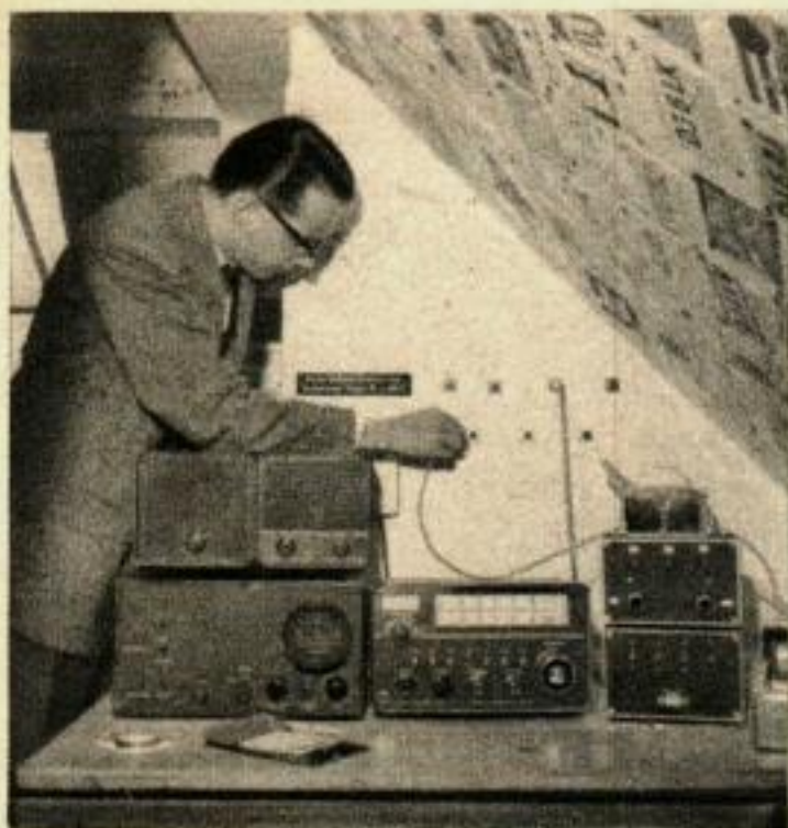
En enfonçant le fil dans une fiche, il choisit l'une des neuf antennes contrôlées à distance. Chacune est réglée pour la réception d'une fréquence particulière.
