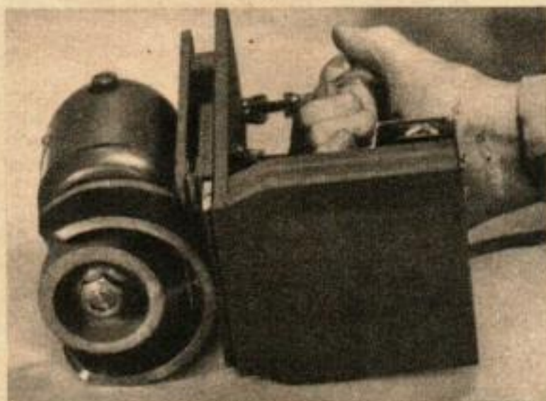
LA VUE D'EN DESSOUS de la meule nous montre comment la meule n° 6 s'adapte parfaitement dans le protecteur. La base de la meule est plus haute que le bord du protecteur qui est de niveau avec l'isorel.
