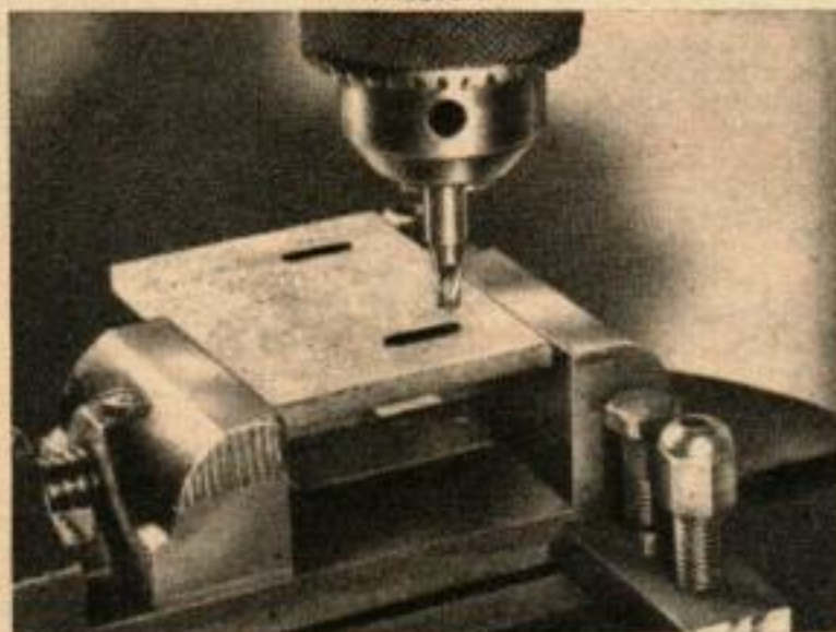
LES FENTES DANS LA PIECE F peuvent être percées à l'aide d'un foret de 6 mm ou d'une mèche à trois pointes pendant que la pièce à travailler est maintenue dans un étau. Vous pouvez également employer une mèche ordinaire pour les trous qui se chevauchent. Les fentes retiennent les talons des boulons.
