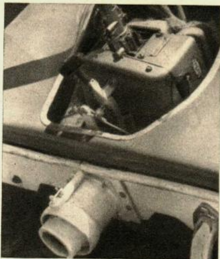
UN PETIT MAIS PUISSANT ENSEMBLE propulseur relie un inboard West Bend à un moteur Jet Berkley 5 J 5. Celui-ci convient particulièrement au « hydro-karting récréatif ».
