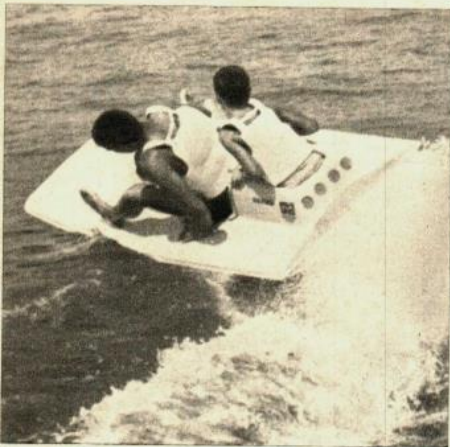
SUR LE KART A DEUX PLACES conçu par Dolphin, le passager est assis sur un siège surélevé derrière le pilote. Il évolue grâce à un moteur inboard McCulloch monté à l'avant.
