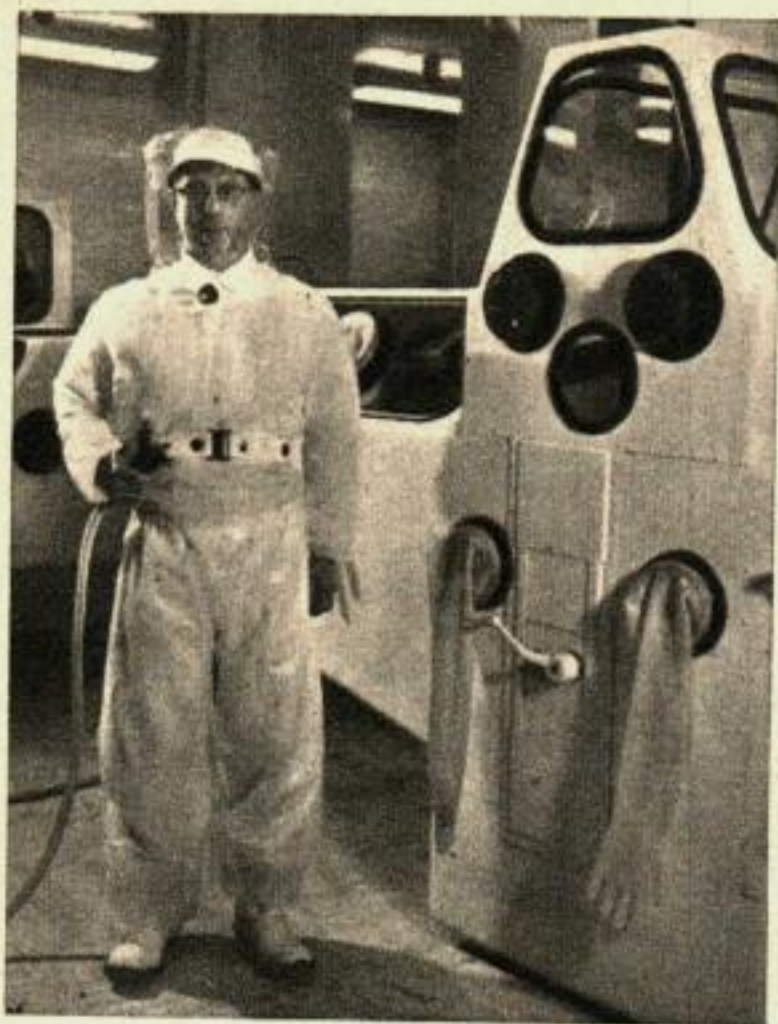
3. S'il existe le danger d'un dégagement de poussière de béryllium, les techniciens endossent des costumes spéciaux pressurisés en polythène équipés d'un appareil respiratoire indépendant.
