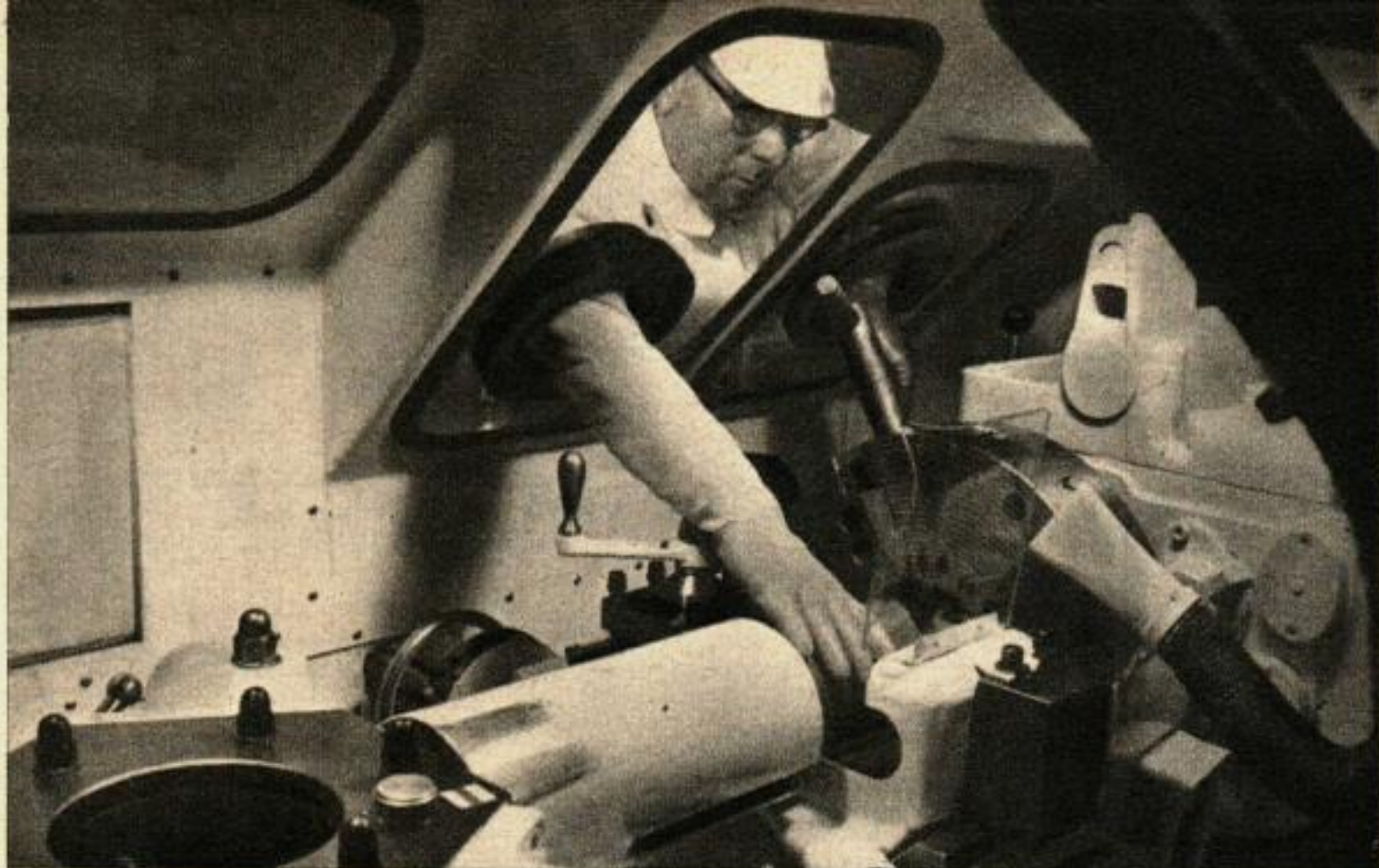
1. En raison des mesures de sécurité pour la santé des employés, cette machine d'une usine à Coventry est équipée de gants et bracelets en caoutchouc. Pour chaque franc dépensé sur la machine, on dépense trois francs pour la protection de l'employé.
