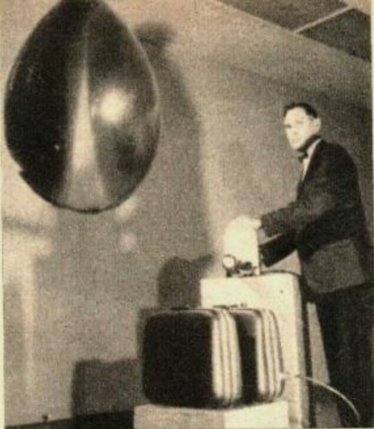
PERÇANT UN TROU par effet de chaleur à travers une plaque d'acier inoxydable, le faisceau du laser réalisé par la Raytheon Co a fait éclater un ballon 3 m plus loin. La tache lumineuse qu'on voit sur le ballon à gauche est due au faisceau laser.
