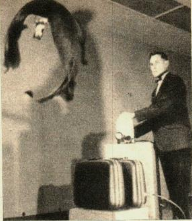
PERÇANT UN TROU par effet de chaleur à travers une plaque d'acier inoxydable, le faisceau du laser réalisé par la Raytheon Co a fait éclater un ballon 3 m plus loin. La tache lumineuse qu'on voit sur le ballon à gauche est due au faisceau laser.
