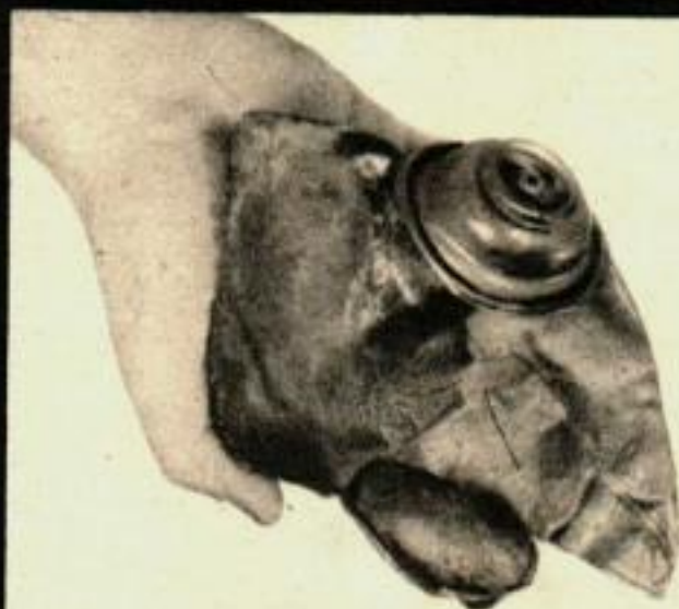
LA PRESSION portée à un point élevé par la chaleur a fait éclater cette boîte en arêtes coupantes.
