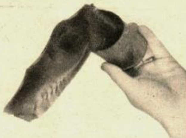
L'EXPLOSION intérieure a déchiqueté cette boîte en éclats dangereux.
