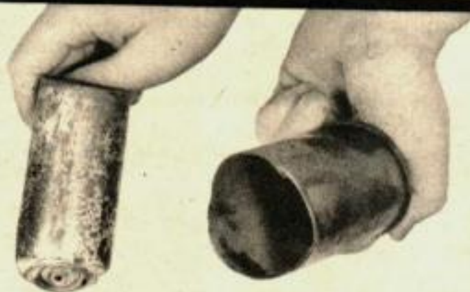
L'EXPLOSION intérieure a déchiqueté cette boîte en éclats dangereux.
