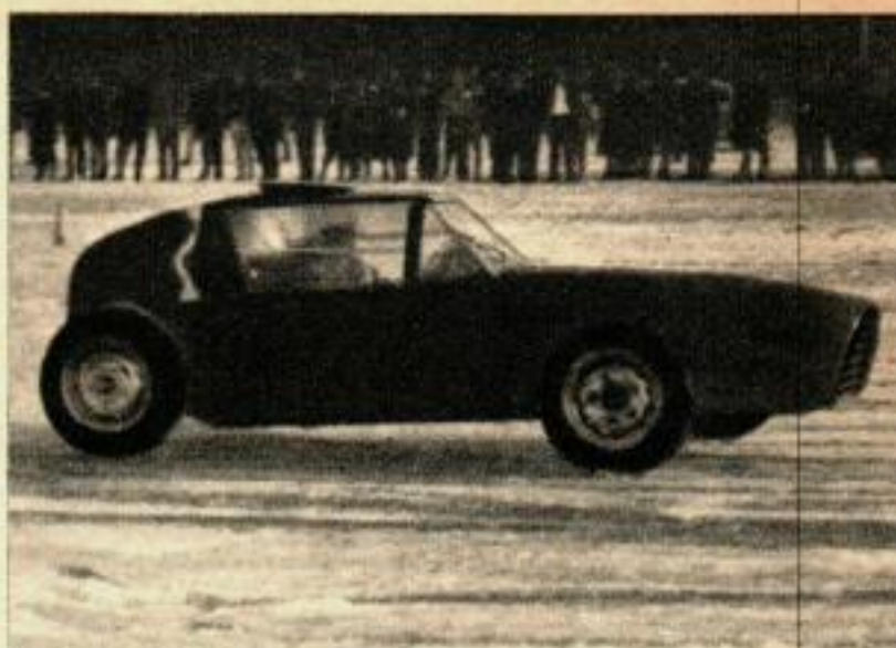
La voiture spéciale pour compétitions sur glace a été construite par l'ingénieur en retraite Al Stout, en partant d'une voiture de course Saab. C'est une monoplace à trois carburateurs qui détient le record de la piste avec 185 km/h.
