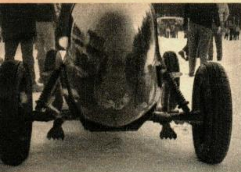
Les freins en forme de fourche sur l'A. S. Special descendent à l'arrière pour s'agripper à la glace et pour garder l'avant de la voiture vers le haut dans les virages. Elle est hors-concours.
