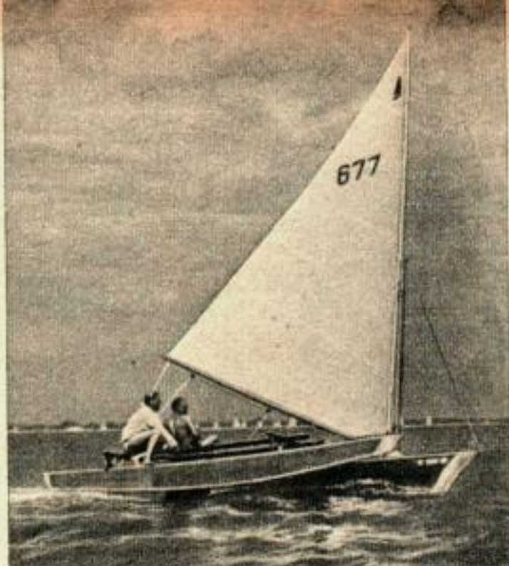
Le MALIBU à balancier, version moderne de la pirogue polynésienne, a deux nacelles ; le mât est planté dans la plus grande.
