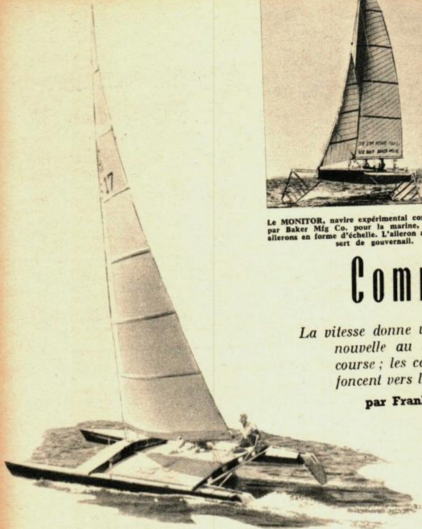
Le SEALION, poids-plume de 7,6 m, ne pèse que 1 200 kg. Ses fines nacelles de fibre de verre sont bordées de mousse plastique.
