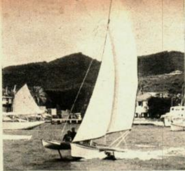
Le TRIMARAN, de 7,3 m, a des ailerons de stabilisation sous les petites coques, fait 20 nœuds avec 25 m 2 de voilure. Le patron est Dick Newick, des Virgin Islands d'Amérique.
