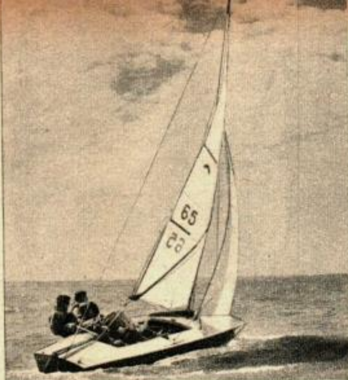
LES SANGLES D'EQUILIBRE fixées en avant et en arrière des deux côtés du bateau, permettent aux passagers de se pencher du côté du vent sans risquer de boire la tasse.
