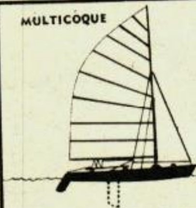
Le SEALION, poids-plume de 7,6 m, ne pèse que 1 200 kg. Ses fines nacelles de fibre de verre sont bordées de mousse plastique.
