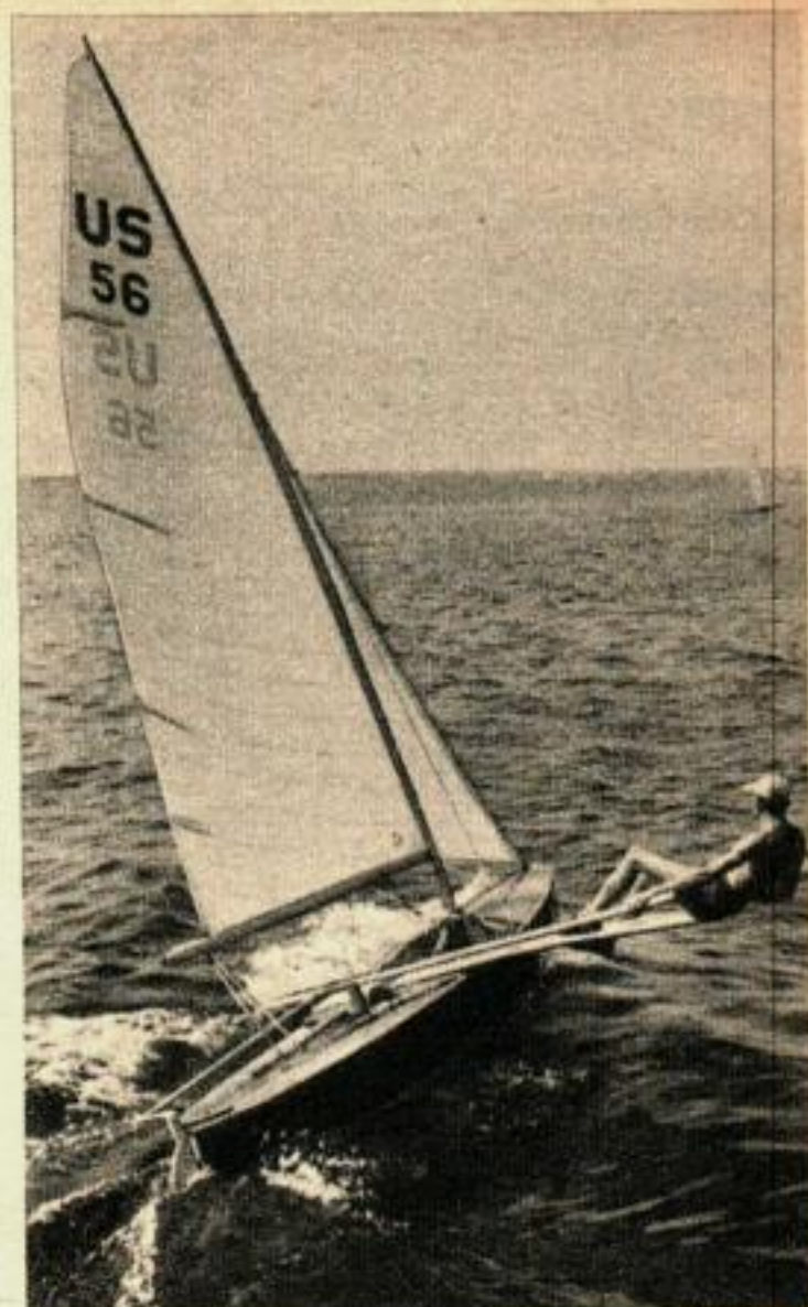
LA PLANCHE D'EQUILIBRE , encore en usage dans la catégorie International Decked Sailing Canoe, a été en général remplacée par le trapèze. Noter la rallonge du gouvernail.
