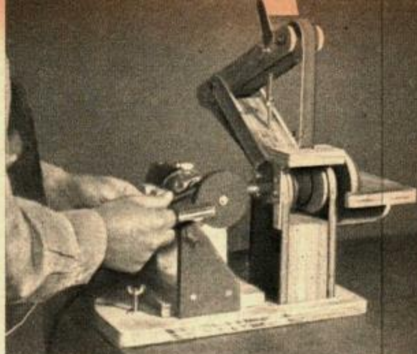
Pour poncer sur tranche, remonter la platine vers une position horizontale et fixer la butée.
