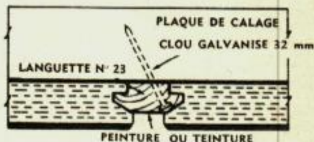
JOINT PAR LANGUETTE A RAINURE MINCE
