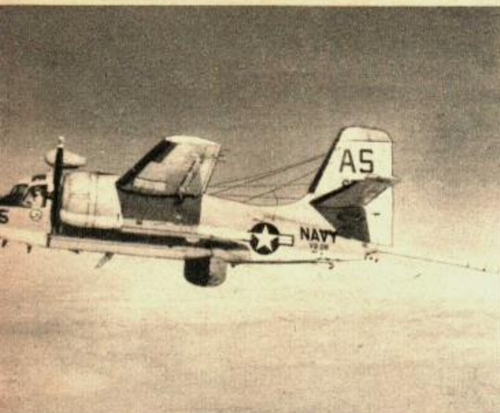
Les traqueurs « S-2D » équipés de torpilles conventionnelles, bombes, fusées et bombes nucléaires pour grandes profondeurs volent à 140 nœuds et peuvent rester plusieurs heures en mission de patrouille.
