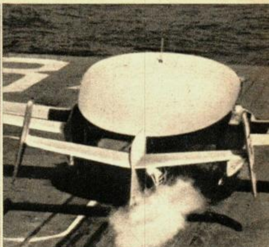
L'avion de reconnaissance « E-1B » ne sert qu'à cet effet. Il ne porte pas d'armes, mais son radar en forme de parapluie à grande portée peut dépister les périscope des sous-marins très éloignés.
