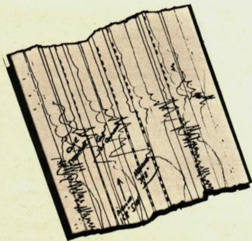
Enregistrement réalisé lors du vol de l'auteur. Le graphique représente le vol de l'avion au-dessus du poste VORTAC de Shreveport. Le gribouillage indique le moment où l'avion passe directement au-dessus de la station et les signaux sont momentanément effacés. Les tracés sont ensuite analysés par des calculateurs électroniques.
